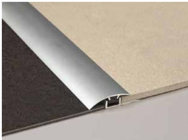
Perfil terminal para conectar desniveles entre 0÷6 mm patentado para pavimentos LVT. Los elementos que componen el sistema MULTICLIP se combinan perfectamente entre sí gracias al clip de material plástico, proporcionando al sistema resistencia, ajuste y flexibilidad. La ligera rotación del perfil de acabado permite que el perfil se ajuste perfectamente al desnivel a conectar.
